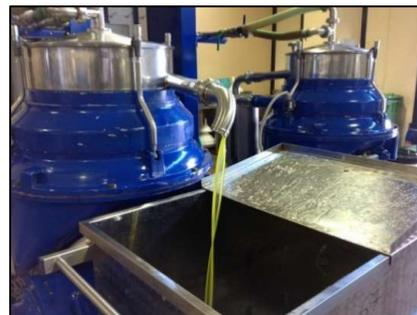
FASE 4 -5 Separazione con centrifuga (5 min)
